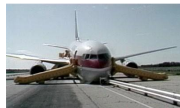
Fig.7.1. El avión del vuelo 143 de Air Canada luego del aterrizaje forzoso debido a un mal cálculo de transformación de unidades
