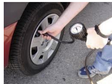
Fig. 7.8. La presión manométrica de las cubiertas se mide aún hoy en psi.
